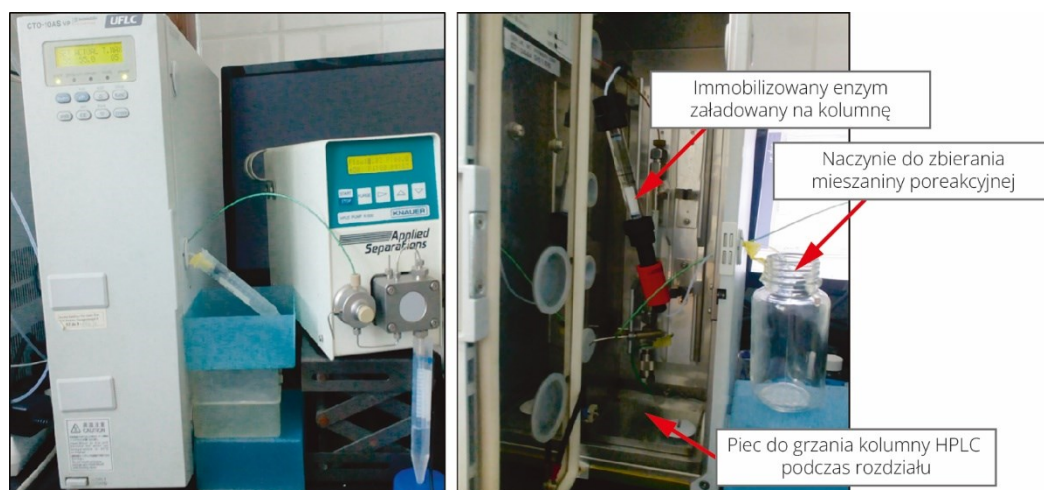
Rys. 7. Schemat reaktora przepływowego w skali analitycznej skonstruowanego we współpracy z dr inż. Mateuszem Tataruchem.
