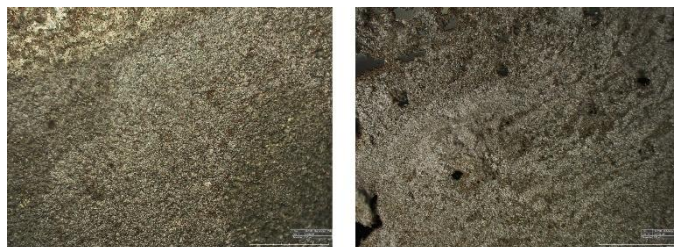
Obraz mikroskopowy tuszu przewodzącego sformułowanego z nanodrutami Cu@Ag rozproszonymi w glikolu dietylenowym (DEG).
